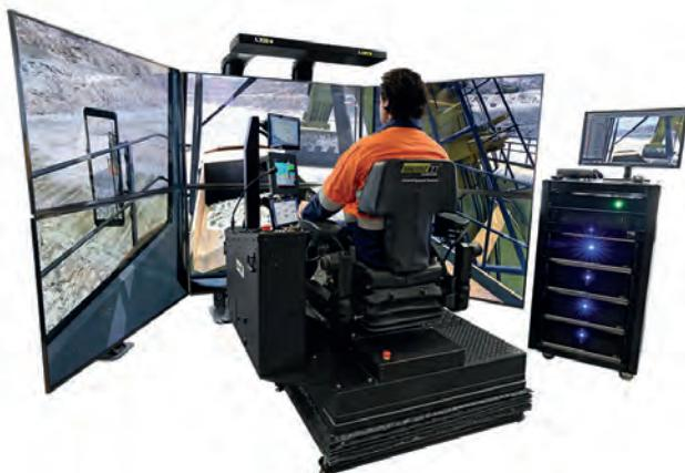
*El simulador LX6+, diseñado para un alto rendimiento, combina un diseño compacto listo para el aula y la funcionalidad de base móvil.*
