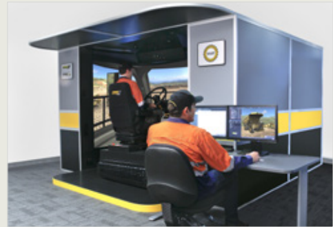
PRO3-B mencakup tatap muka dua layar yang memungkinkan pelatih untuk memantau dan mengendalikan sesi simulasi dan sekaligus melakukan kerja administrasi serta membuat laporan pada saat yang bersamaan.
